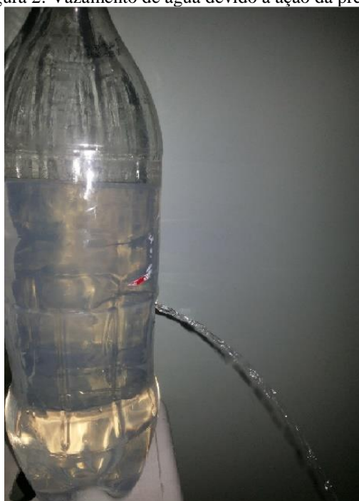
Figura 2: Vazamento de água devido à ação da pressão
