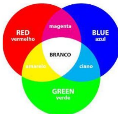
Figura 1 - Representação da síntese aditiva de cores
