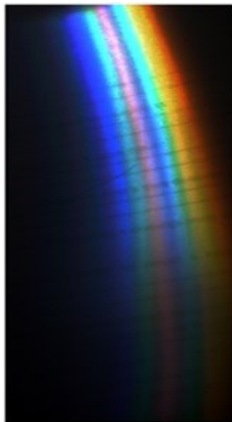
Figura 7 - Linhas espectrais obtidas com o prisma
